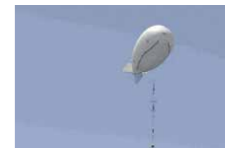
▲ L'aéroclipper est un système bouée-ballon dérivant à la surface de la mer
